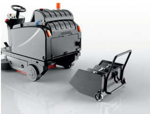
Depósito com rodas com mini depósitos opcionais
